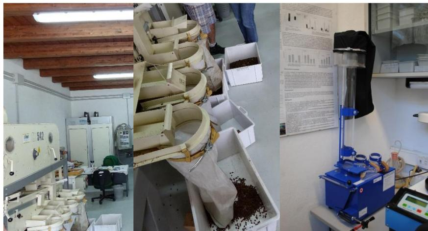
Figura 16. Separador de semillas mecánico de gran tamaño y pequeño aparato aventador (Fotos: D. Ballesteros, M. Porceddu).
